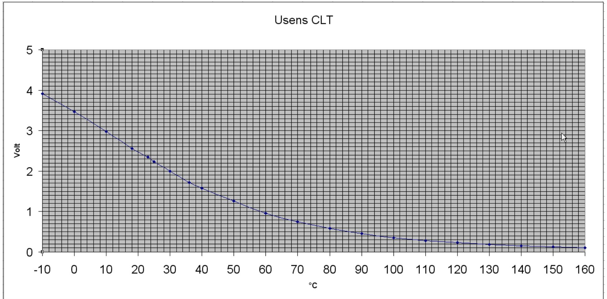
Spi Wassertempersensur. Messung in eingebautem Zustand, Motor läuft bzw. Zündung an.
