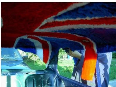
Die Abschlüsse an den Holmen kann man ebenfalls kleben, in dem man den Stoff umklappt und vertklebt. Hier kann man aber auch Köder, Klebeband oder was auch immer als Abschlusskante nehmen. Wichtig ist nur, dass es noch in die Dichtungsgummis der Tür und Fenster passt.
