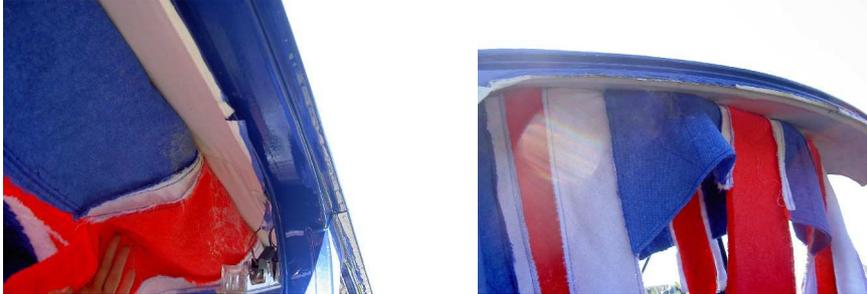
Wenn der Himmel angeklebt ist kann es mit der Fahne weitergehen. Die Fahne wird nun zu erst an den Fenstern bis zur Fensterkante heran verklebt.
