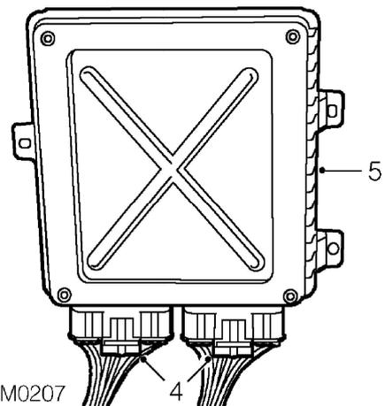
2. Schraube zur Befestigung des ECM am Halter entfernen.
