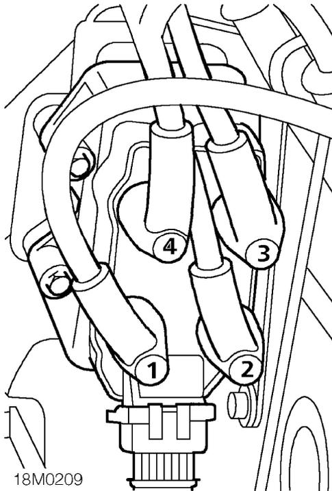
2. Zündkabel identifizieren und an Zündspule anschließen.
