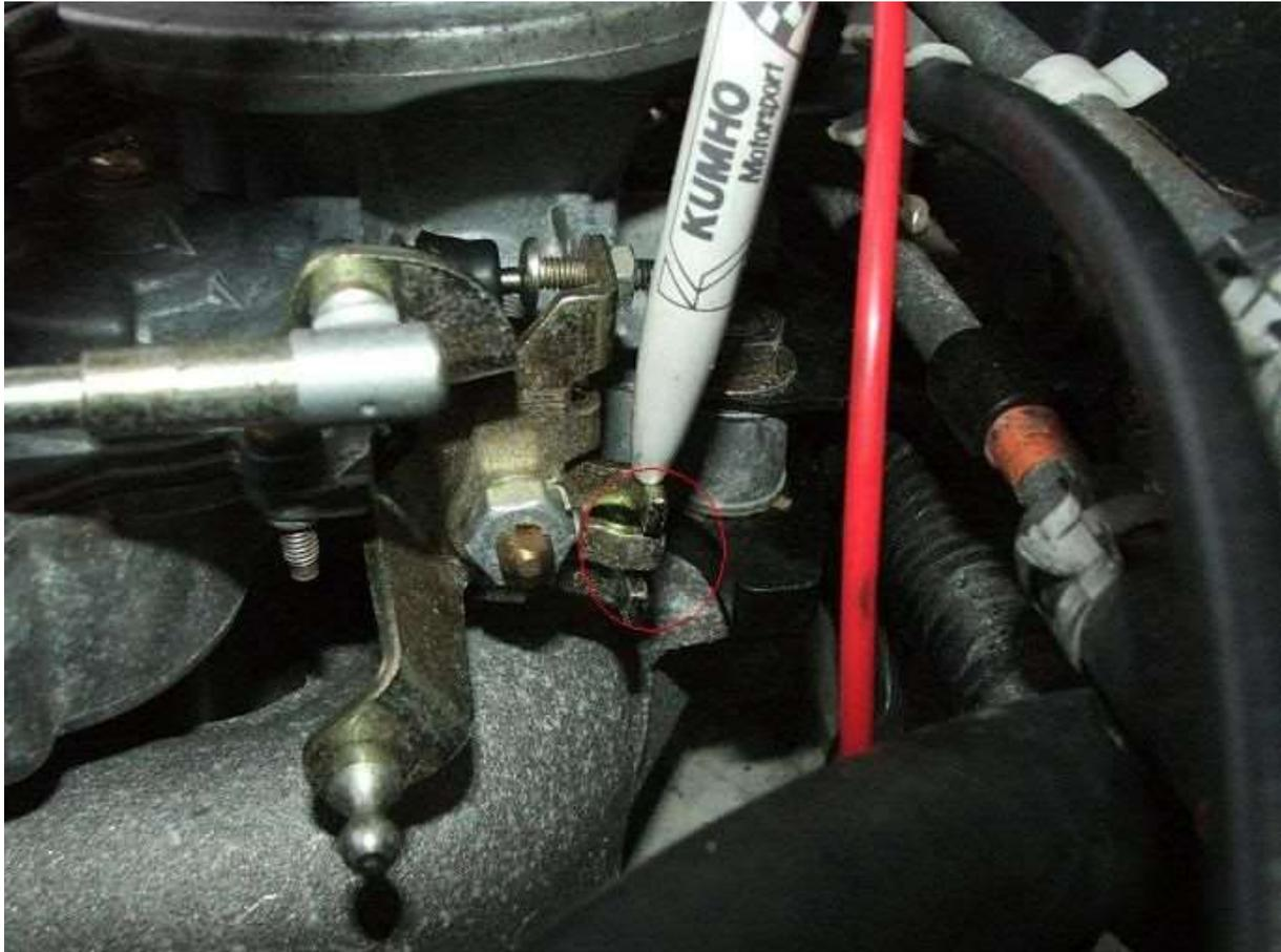
Stellen Sie diese Schraube unter keinen Umständen ein, ohne dass Sie Zugang zu einer Diagnoseeinheit haben, mit der die Leerlaufdrehzahl eingestellt werden kann. Die Leerlaufdrehzahl kann ohne diese Diagnose nicht eingestellt werden. Der Schrittmotorkolben ist links zu sehen. Er wirkt auf diese Schraube und stellt die Leerlaufdrehzahl ein
