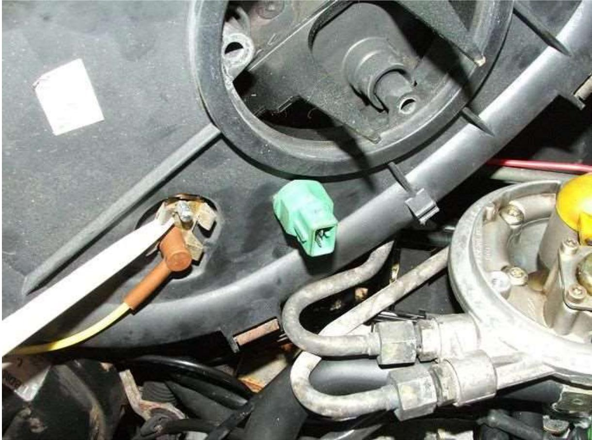
Diese Kapillare versorgt das Luftfilter-Einlasslufttemperatur-Steuersystem mit Vakuum, das eine Klappe im Inneren des Gehäuses betätigt, Luft über den Auspuffkrümmer saugt und ihn erwärmt, um einen reibungslosen Betrieb bei Kälte und Gefriertemperaturen zu unterstützen.
