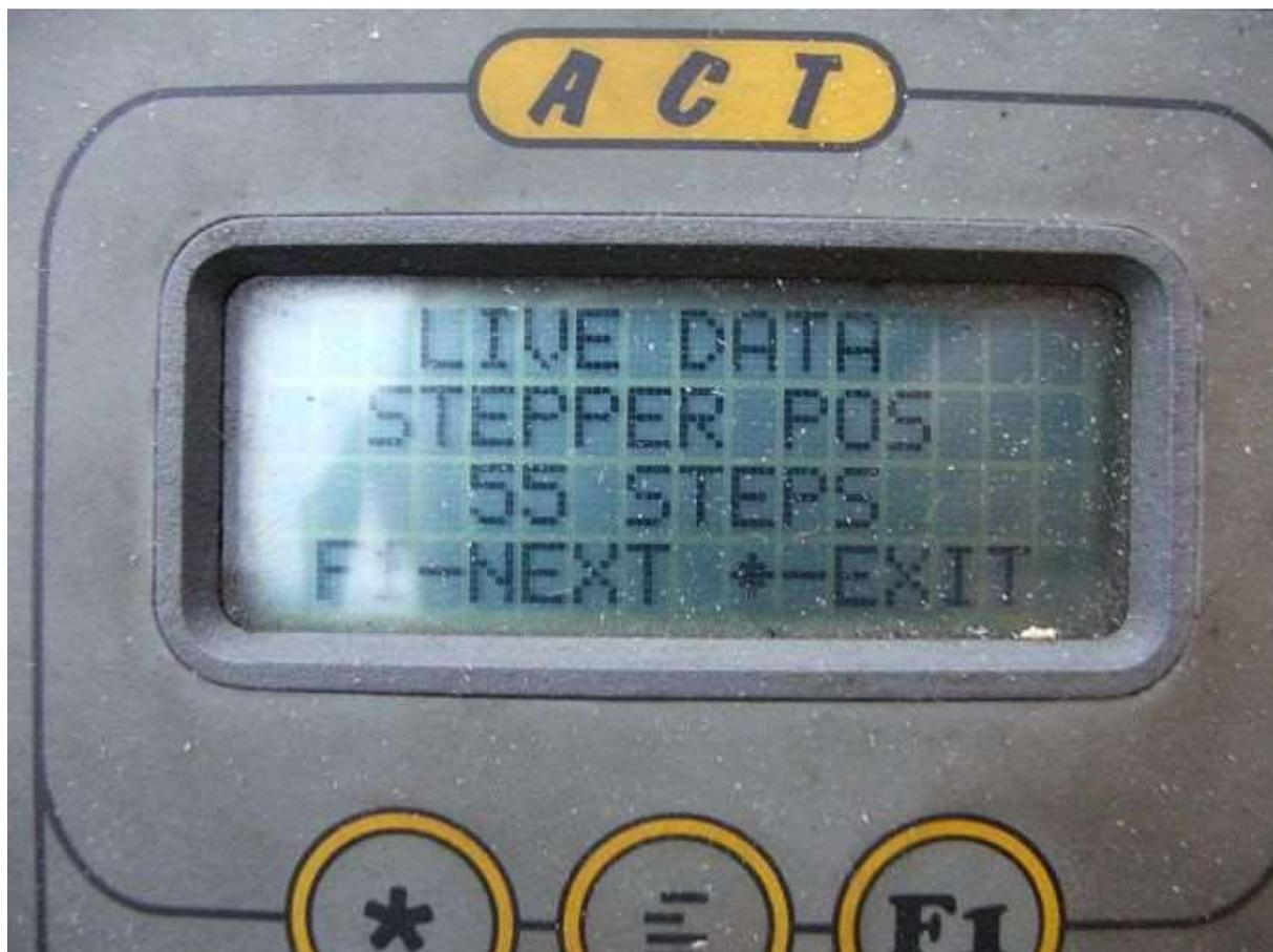
Probleme treten auf, wenn diese Leerlaufdrehzahlschraube ohne Diagnosegerät eingestellt wurde, was im schlimmsten Fall dazu führt, dass der Stepper entweder bei Nullstufen ist und die Leerlaufdrehzahl oder die vollen Stufen nicht senken und die Leerlaufdrehzahl nicht erhöhen kann.
