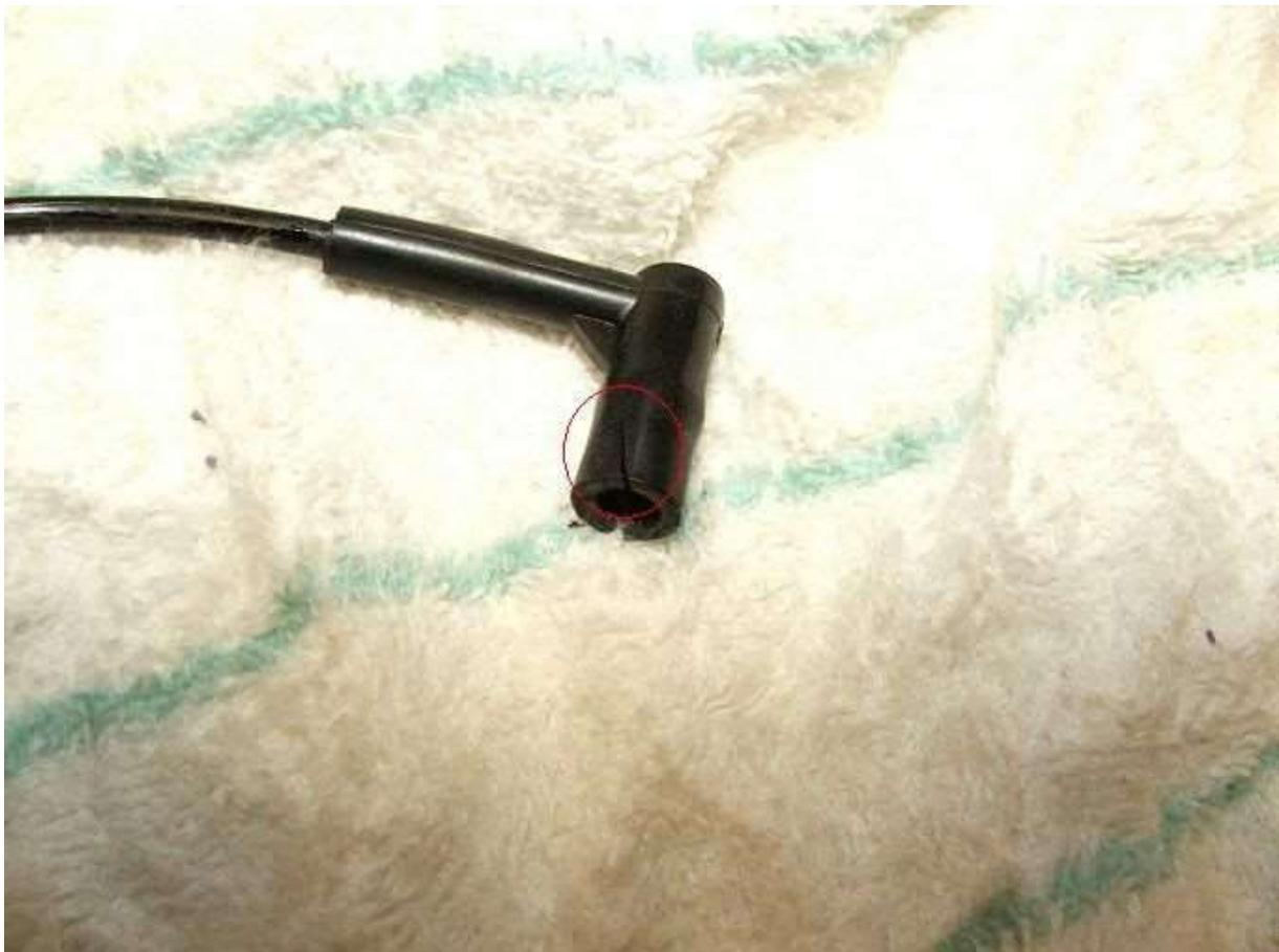
Der Hauptverursacher scheint das am Ende der mit Weiß gekennzeichneten kurzen Leitung von der Rückseite des Einlasskrümmers bis zur Kraftstofffalle. Der Anschluss befindet sich auf der Rückseite des Einlasskrümmers und ist erneut mit Weiß gekennzeichnet. Oben am Einlasskrümmer befinden sich zwei Anschlüsse. Überprüfen Sie, ob die Rohre frei sind. Manchmal, wenn die Winkel zu stark aufgedrückt werden, wird das Rohr blockiert. Von hier aus (weiß) geht's zur Kraftstofffalle.
