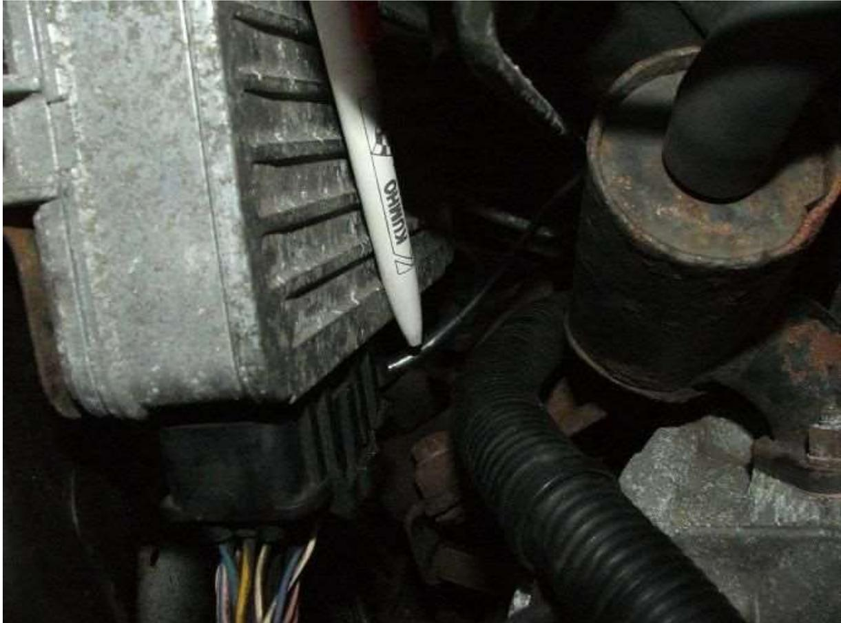
Weitere Stellen für Luftlecks sind die Schläuche des Entlüftungssystems und das System zur Kontrolle der Verdunstungsemissionen. Überprüfen Sie, ob alle Gummischläuche in gutem Zustand sind, keine Risse oder Beschädigungen. Die zu prüfenden Hauptentlüftungsschläuche sind diejenigen, die das Spülventil und den Holzkohlebehälter versorgen. Sie lecken normalerweise am hier gezeigten Spülventil.
