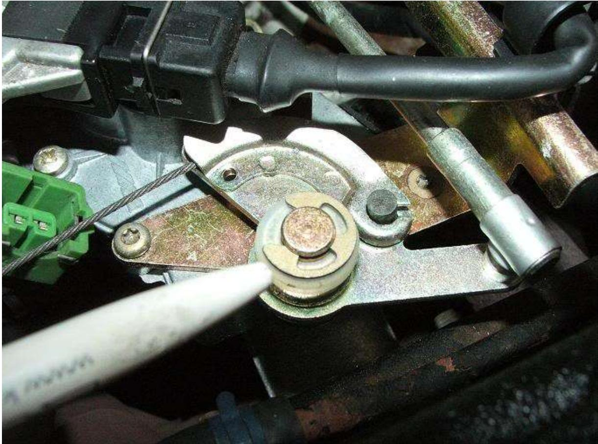
Dadurch wird der Schrittmotor in die richtige Position gebracht, damit Sie das Kabel einstellen können.
