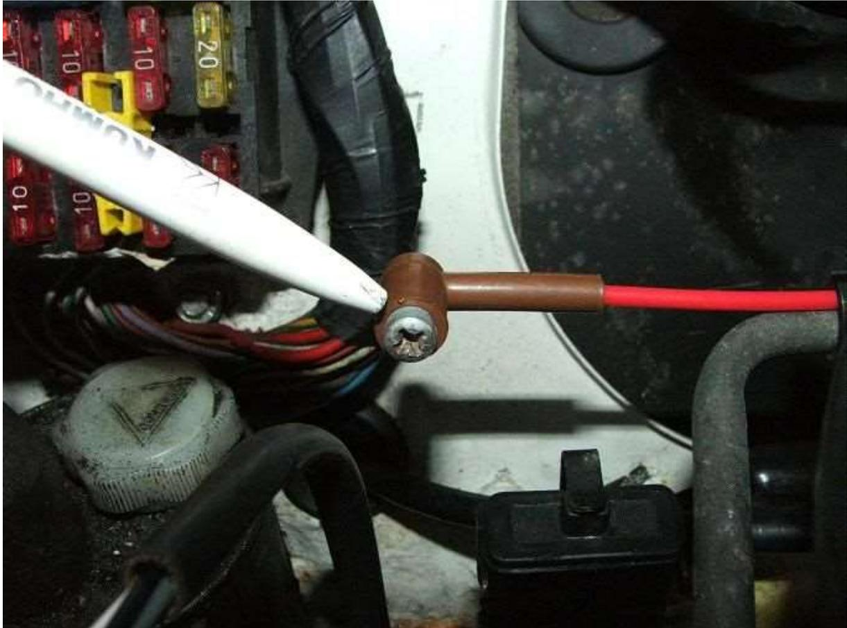
Der Sensor kann gelesen werden, wenn er mit einem Diagnosetool wie dem Crypton ACT an das System angeschlossen wird. Wird der Motor, was für Testläufe oft geschieht, ohne angeschlossenen Luftsensoren gestartet, so wird ein Fehler für den Sensor in der ECU gespeichert.
