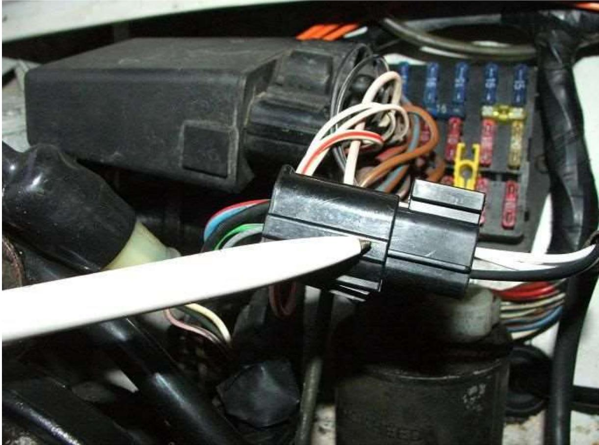
Ein Diagnosewerkzeug liest den Sensor und schwingt von Hoch- zu Niederspannung
