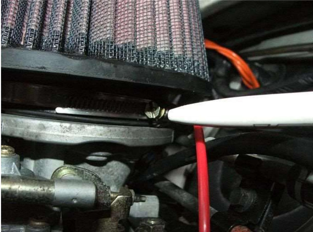
Achten Sie beim Einbau darauf, dass die Filteroberflächen und das Einspritzgehäuse frei von Öl sind, und drücken Sie die Schraube nur so weit ein, dass sich der Filter nicht bewegt. Wenn Sie diese Schraube zu fest anziehen, springt der Filter mit der Zeit ab. Diese IMHO ist ein Konstruktionsfehler von K & N. Es ist bekannt, dass einige Leute Kabelbinder verwenden, um das Ding an Ort und Stelle zu halten.
