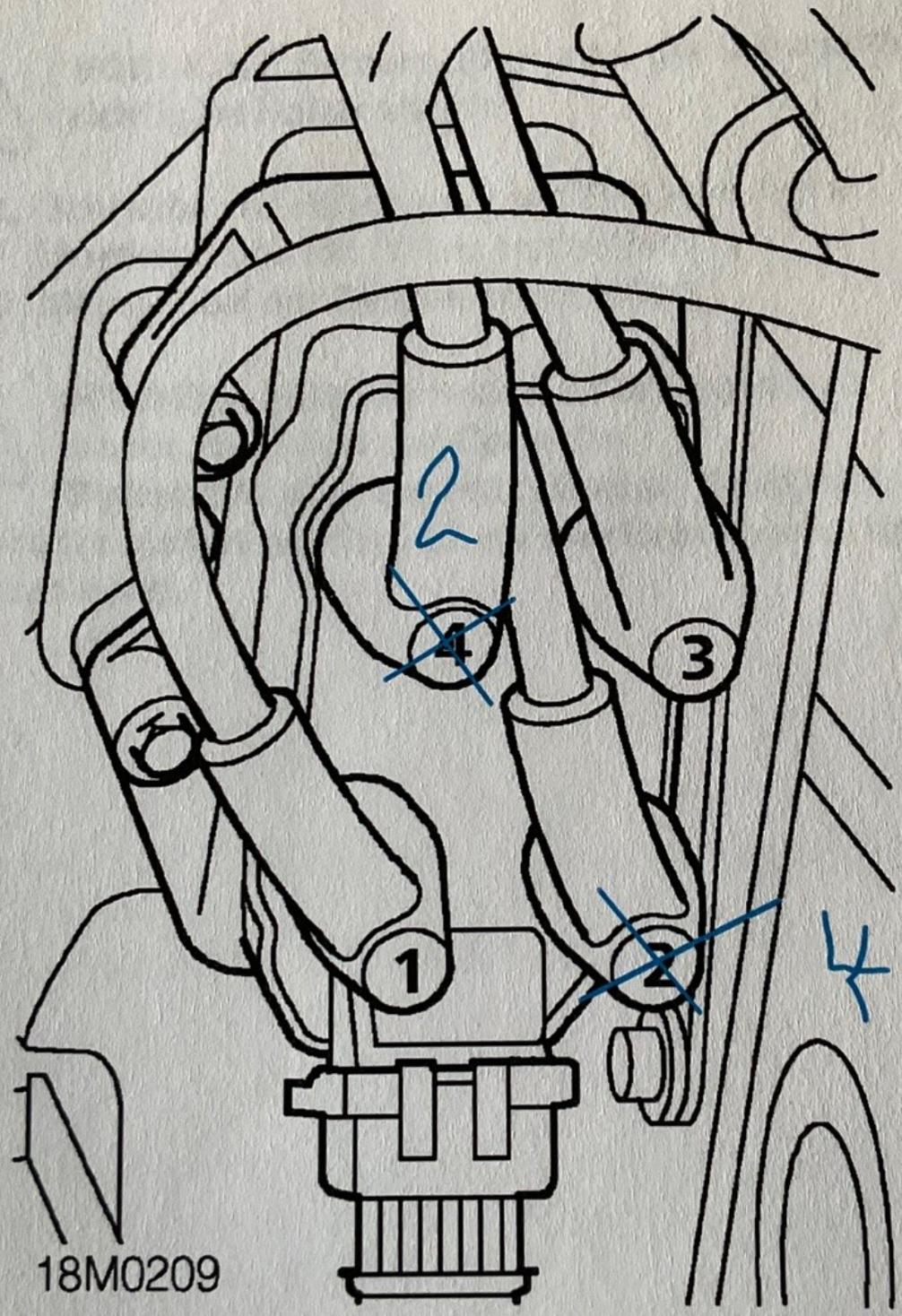
2. Zündkabel identifizieren und an Zündspule anschließen.
