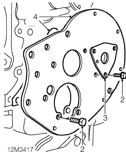
2. 5 verbleibende Schrauben zur Befestigung des Stirndeckels entfernen.
