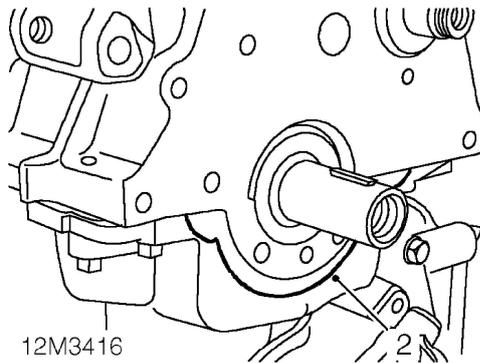
2. Dichtung aus der Fuge unter dem Hauptlagerdeckel vorn entfernen.
