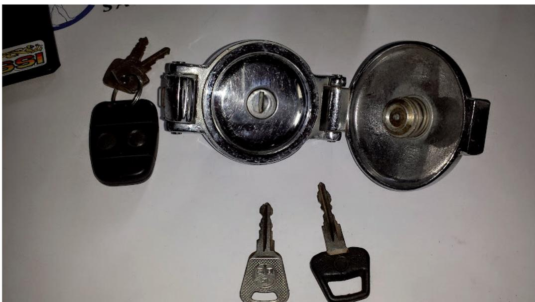
Als erstes muss der Hohlspannstift auf der Innenseite des Tankdeckels ausgetrieben werden. Dazu einen 2mm Austreiber, oder wenn keiner zur Hand ist, einen alten 2mm Bohrer nehmen.
