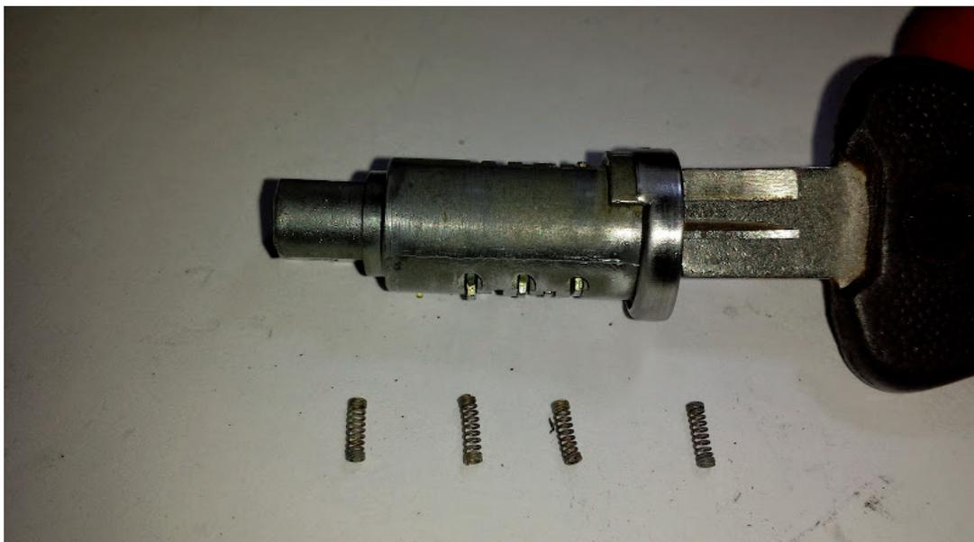
Der Rest der jetzt noch zu lang ist, muss abgeschliffen werden. Das geht mit einer Schlüsselfeile oder mit einem Dremel und kleinem Fräser. Beim Feilen oder Fräsen immer mit dem Finger von unten gegen die Plättchen drücken. Um die Oberfläche des Zylinders und der Plättchen wieder schön glatt zu bekommen kann man eine Nagelfeile, oder Silikon-Polierscheiben für den Dremel nehmen.
