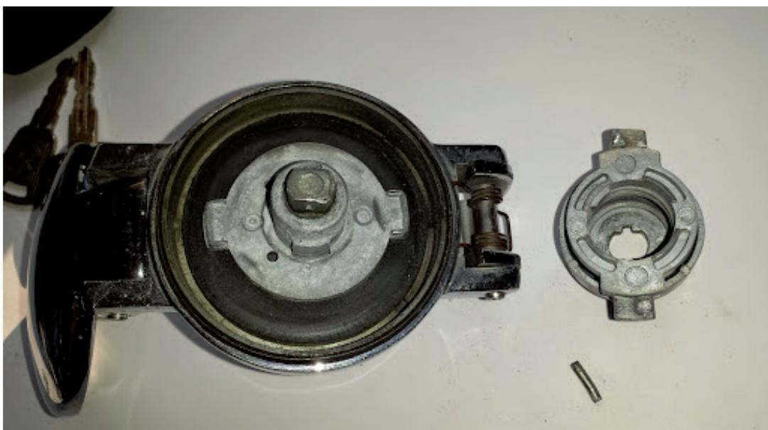
Nun den Schlüssel für den Tankdeckel ins Schloss stecken und den ganzen Zylinder herausziehen.
