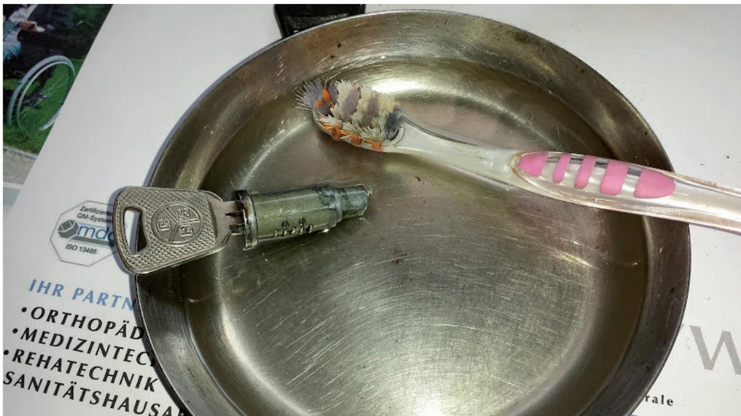
Jetzt den Tankschlüssel vorsichtig aus dem Zylinder ziehen und den Zündschlüssel reinstecken. Wie man sieht stehen einige Schließplättchen aus dem Zylinder raus, was ein drehen des Zylinders im Tankdeckel unmöglich macht.
