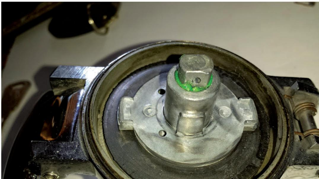
Nun die Verriegelungsplatte, Feder und Kappe in umgekehrter Reihenfolge wieder zusammenbauen und den Hohlspannstift wieder einschlagen. Wenn alles richtig gelaufen ist, lässt sich nun der Tankdeckel mit dem Zündschlüssel öffnen und der alte Tankdeckelschlüssel nicht mehr passen, der kann entsorgt werden
