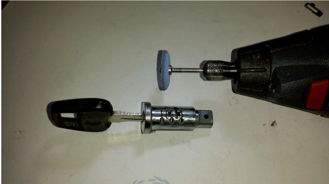
Wenn dann bei eingestecktem Zündschlüssel die Plättchen bündig sind, den Zylinder ausblasen, das keine Späne oder so mehr im Zylinder sind. Dann die Federn und Plättchen wieder verbauen und mit einem leichten Silikonfett einstreichen.
