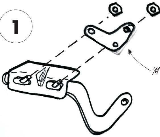
REMOVE NUTS, SLIDE 'M' BRACKET OVER STUDS, DO NUTS BACK UP
