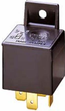
Relais permettant la commutation d'équipement divers (phares, avertisseur, sirène, etc). Sortie sur cosses faston 6,35 mm. Pouvoir de coupure 20 A. Alim 12 V.
